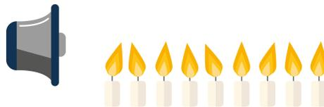
**Expérience de la flamme dansante:** Mise en évidence de la propagation des vibrations dans l'air lors de la production d'un son.
