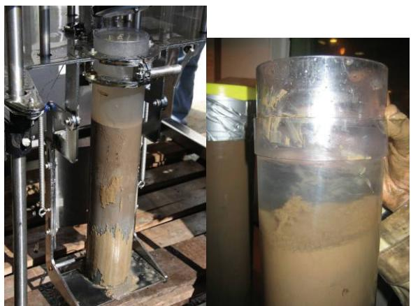
*Multicarottier de BCCR (Bergen) après prélèvement et vues de l'un des tubes*
