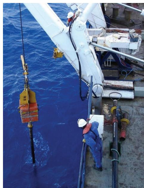
④ Un piston, au bout du câble, reste à la surface du sédiment pendant le carottage pour éviter la déformation de ce dernier et permet ensuite de remonter le tube avec le sédiment.
